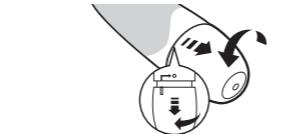
2. Установите алкалиновую (щелочную) батарею типа AAA таким образом, чтобы положительный (+) и отрицательный (-) контакты совпадали с полярностью, указанной в отсеке для элемента питания.
